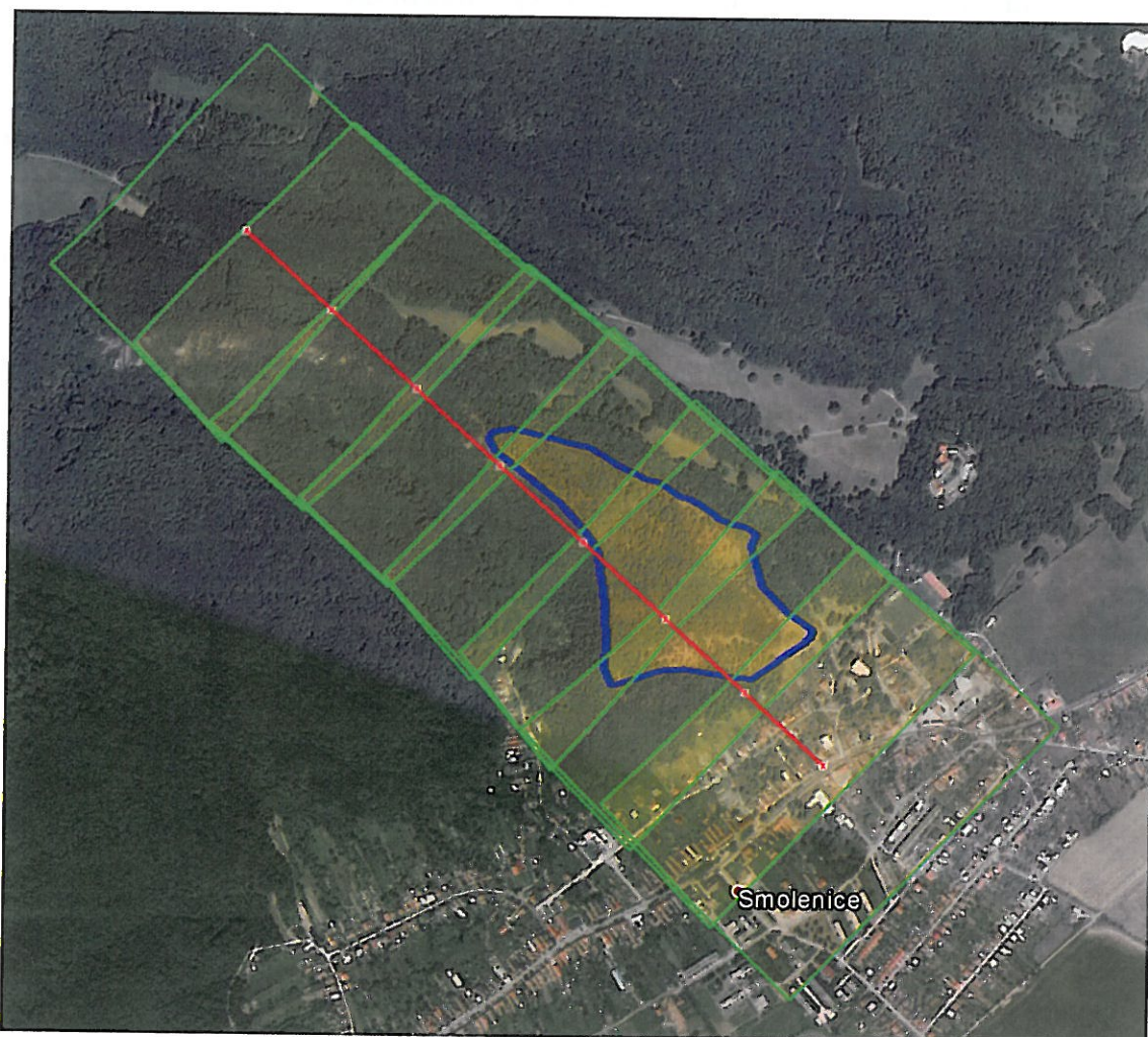
Obrázok 1: Plán letu: Hranica záujmového územia (modrou farbou), dráha letu (červenou farbou), nasnímané letecké snímky (zelenou farbou)
